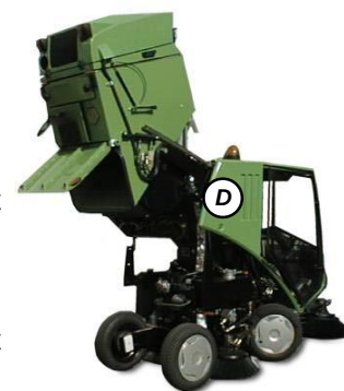
FIG. 22 REFROIDISSEMENT HUILE HYDRAULIQUE
