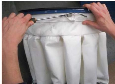
Enlevez les noeuds et extrayez le filtre à poches. Insérez le nouveau filtre et remontez soigneusement l'ensemble en bloquant la calotte.
