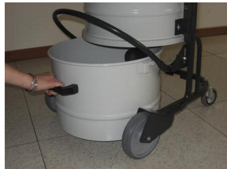
Vider le matériel aspiré présent à l'intérieur de la cuve dans un conteneur approprié, destiné l'élimination des déchets, conformément aux lois en vigueur dans le pays d'utilisation de l'aspirateur.
