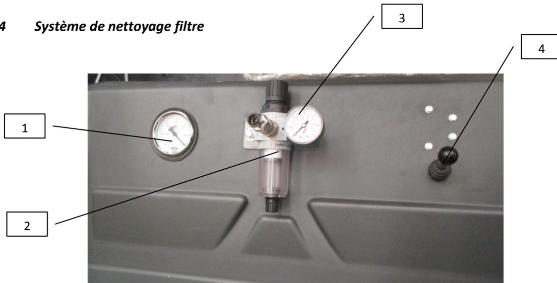
Sur la partie postérieure de l'aspirateur il y a un indicateur de vide (1), un système pour le réglage et la filtration de l'air comprimé à l'entrée du réservoir (2), un indicateur de la pression du réservoir (3) et un levier pour le secouement pneumatique du filtre (4).
