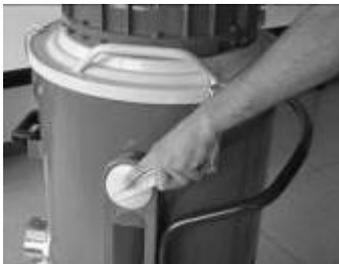
Lever simultanément les deux leviers pour débloquer la cuve.
