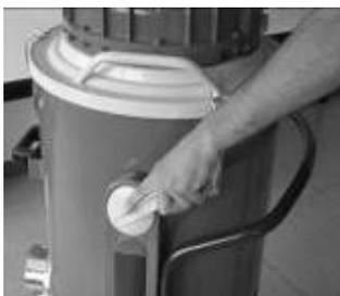
L'opération de blocage de la cuve doit être effectuée par une seule personne qui doit abaisser les deux leviers latéraux simultanément avec les deux mains.
