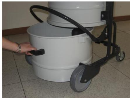
Vider le matériel aspiré présent à l'intérieur de la cuve dans un conteneur approprié, destiné à l'élimination des déchets, conformément aux lois en vigueur dans le pays d'utilisation de l'aspirateur.
