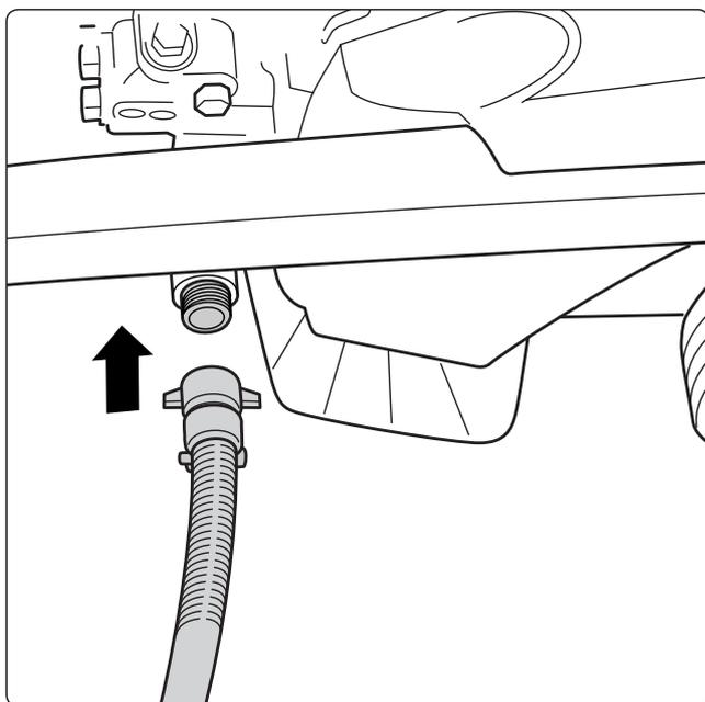
Brancher le tuyau d'aspiration. Le diamètre nominal intérieur du tuyau doit être de 3/4" = 16 mm au minimum.
