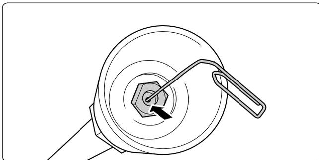
Si la buse reste obturée après une tentative de nettoyage avec un fil métallique, il est alors nécessaire de la démonter pour accéder aux saletés ou de la remplacer si nécessaire.
