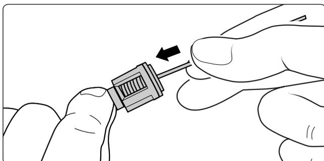
Nettoyez les soupapes avec un fil métallique (trombone) en les passant sous l'eau d'un robinet.
