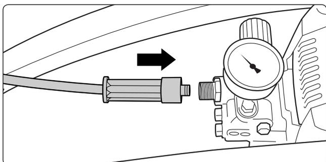
**9.** Mettre l'appareil en position horizontale. **Utiliser l'appareil uniquement dans cette position!** Raccorder le flexible HP à la pompe et bien serrer le raccord.
