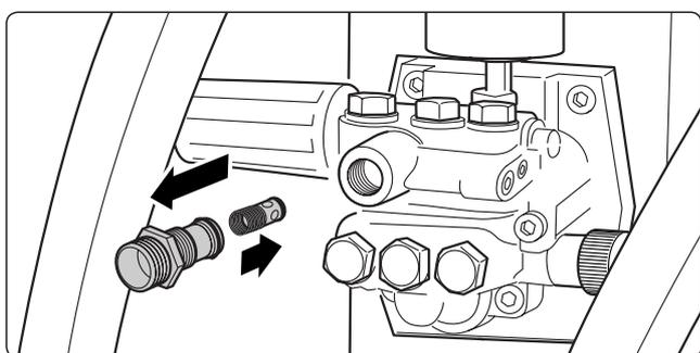
Enlevez le barillet anti-retour. Contrôlez son état de propreté et vérifiez si la bague d'étanchéité n'est pas endommagée.
