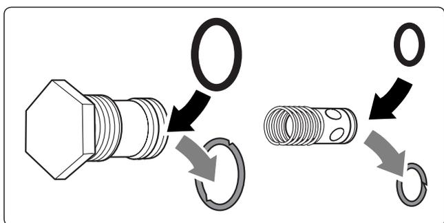
Remplacez la bague d'étanchéité si celle-ci est défectueuse.
