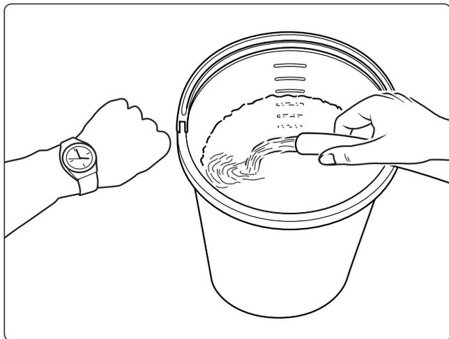
Le manque d'eau se produit bien plus souvent qu'on le croit. Plus un appareil est puissant, plus le risque de manque d'eau est important. Le manque d'eau produit une cavitation dans la pompe (mélange eau-air), ce qu'on ne remarque généralement pas ou trop tard. **Ceci conduit à une détérioration de la pompe.**
