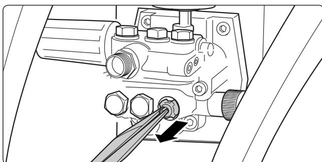
Retirez les corps de soupapes (avec chemises vertes ou rouges en plastique) avec les joints toriques en utilisant une pince à bec pointu. Contrôlez l'état des joints toriques et remplacez-les si nécessaire.
