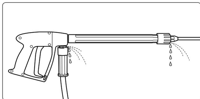
Arrêtez l'appareil. Ouvrez brièvement le pistolet pour dépressuriser le système.
