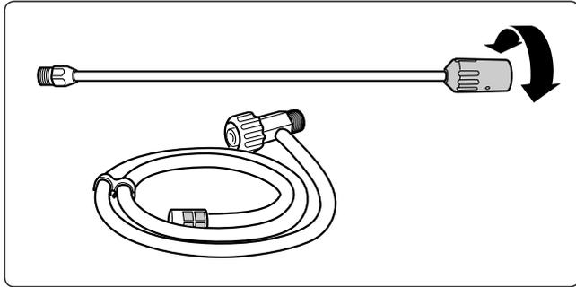
A cet effet, l'utilisation du kit d'aspiration avec buse de régulation entre haute et basse pression est nécessaire, car l'aspiration de l'additif n'a lieu qu'à basse pression. Le réglage de la buse sur haute pression entraîne la coupure de la distribution du produit additif.
