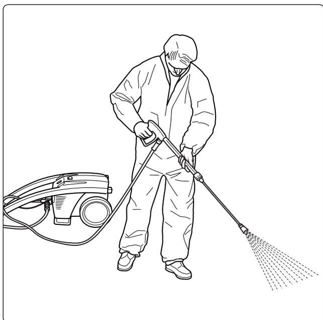
**13.** Mettre le nettoyeur en marche, le pistolet étant **ouvert**, puis chasser l'air de l'appareil: A cet effet, ouvrir et fermer le pistolet à plusieurs reprises. Le nettoyeur HP est désormais prêt pour la réalisation des travaux de nettoyage.
