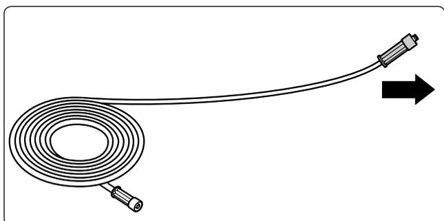
**6.** Dérouler le flexible HP en le tirant dans le sens perpendiculaire à l'axe de l'enrouleur et en veillant à ne pas faire de boucle. (La longueur max. du flexible HP rallongé ne doit pas excéder 20 m !)
