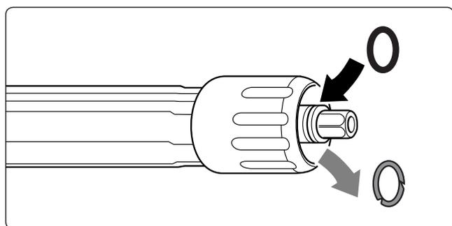
Dévissez le flexible HP, le pistolet et la lance, puis contrôlez l'état des joints d'étanchéité.
