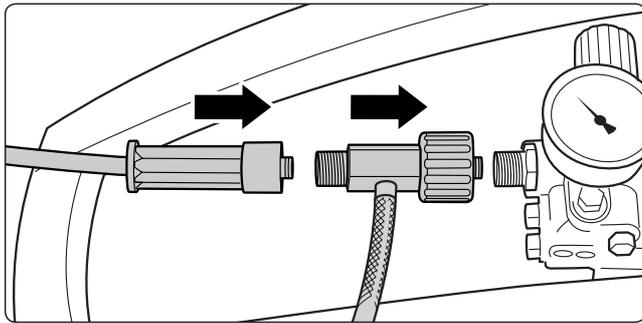
**1.** Dévisser le flexible HP; brancher l'injecteur de détergents sur le manchon de sortie HP puis le raccorder avec le flexible HP.
