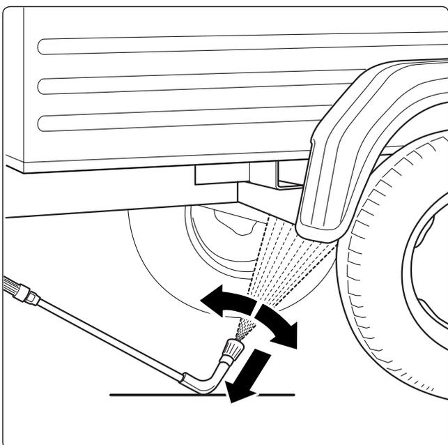
Lors de l'utilisation de la lance bas de caisse, celle-ci doit absolument être en contact avec le sol avant l'ouverture du pistolet. Pour les lances cintrées ou recourbées, le coup de bélier produit un couple de rotation très sensible.
