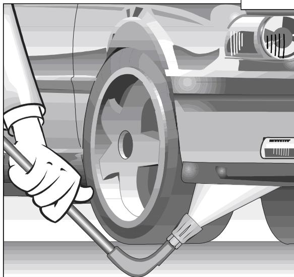
Lors de l'utilisation de la lance bas de caisse, celle-ci doit absolument être en contact avec le sol avant l'ouverture du pistolet. Pour les lances courbées, telle que la lance bas de caisse No 41.075, le coup de bélier produit un moment de rotation!
