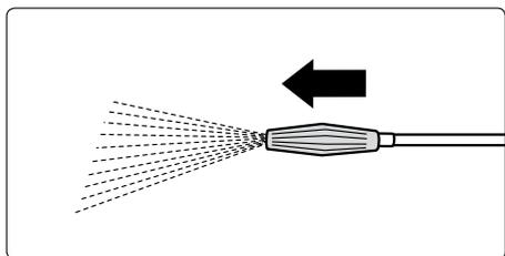
**2.** Pousser la buse Vario-Jet vers l'avant pour le réglage en basse pression afin de permettre à l'injecteur d'aspirer le produit de nettoyage.
