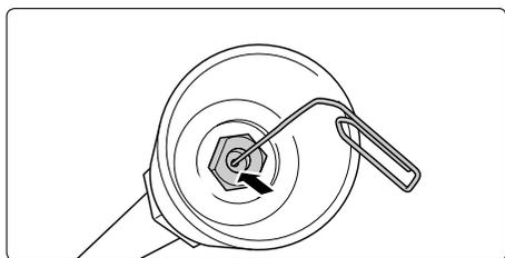
Si la buse reste obturée après une tentative de nettoyage avec un fil métallique, il est alors nécessaire de la démonter pour accéder aux saletés ou de la remplacer si nécessaire.
