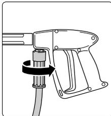
**8.** Raccorder le flexible haute pression au pistolet.
