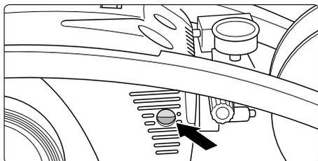
3. Contrôler le niveau d'huile à l'aide de l'indicateur de niveau avant chaque mise en service.
