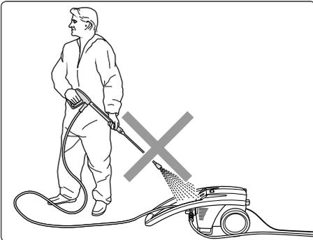
**... nettoyer l'appareil avec le jet haute pression ou diriger le brouillard du jet de pulvérisation sur l'appareil;**
