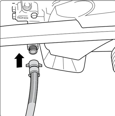
Brancher le tuyau d'aspiration. Le diamètre nominal intérieur du tuyau doit être de  $1/2'' = 12,7 \text{ mm}$  au minimum.
