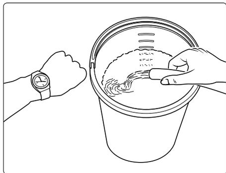
Le manque d'eau se produit bien plus souvent qu'on le croit. Plus un appareil est puissant, plus le risque de manque d'eau est important. Le manque d'eau produit une cavitation dans la pompe (mélange eau-air), ce qu'on ne remarque généralement pas ou trop tard.
