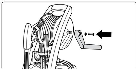
4. 1151 T: Poser l'appareil verticalement sur le sol, puis enlever la vis située dans l'axe à six pans de l'enrouleur. Enfiler la manivelle rabattable sur l'axe à six pans et la fixer en resserrant la vis.
