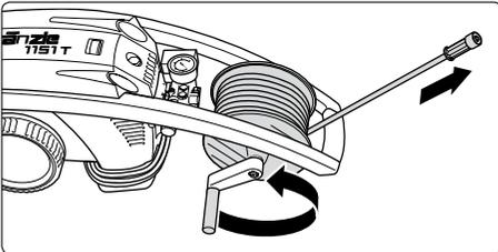
**7.** Dérouler le flexible HP en le tirant dans le sens perpendiculaire à l'axe de l'enrouleur et en veillant à ne pas faire de boucle. (La longueur max. du flexible HP rallongé ne doit pas excéder 20 m!)
