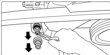
2. Avant chaque mise en service, vérifier si le filtre d'entrée d'eau est propre. Dévisser le raccord du flexible à la main et ôter le filtre d'entrée d'eau monté en série en utilisant une pince pointue. Nettoyer le filtre si celui-ci est encrassé.
