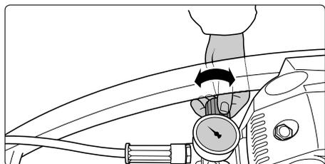
**12.** Régler la pression de service à la valeur souhaitée à l'aide de la poignée de réglage. La pression maximale disponible est pré-réglée en usine à une valeur fixe.
