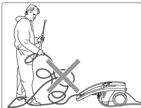
... tendre le flexible haute pression s'il y a formation de boucles, le tirer ou le laisser frotter sur une arête vive;
