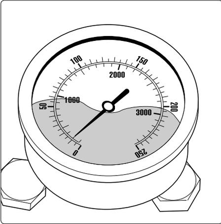
Bien que le régulateur de pression soit entièrement ouvert, la pression indiquée au manomètre est très faible et un jet d'eau irrégulier sort de la lance. Le tuyau haute pression vibre.
