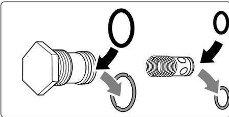
Remplacez la bague d'étanchéité si celle-ci est défectueuse.
