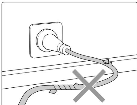
... utiliser un câble électrique qui n'est pas en parfait état, endommager le câble ou effectuer des réparations inadéquates;
