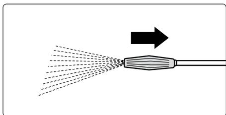
**3.** Tirer la buse Vario-Jet vers l'arrière pour la fermer afin d'interrompre l'aspiration du produit additif. Laisser agir le produit de nettoyage sur la surface à traiter avant de la rincer au jet de pulvérisation à haute pression.
