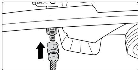
**10.** Raccorder le tuyau d'eau au manchon d'entrée d'eau.
