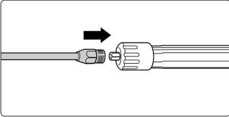
**5.** Brancher la lance de pulvérisation ou la lance à buse Turbo-jet sur le pistolet.
