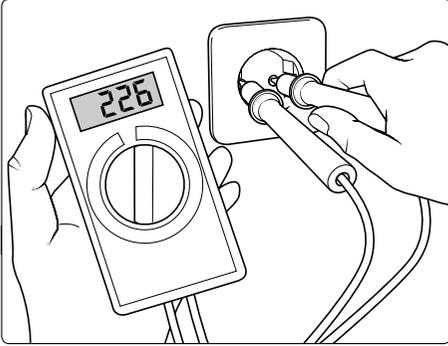
Si un trop grand nombre d'appareils prélèvent simultanément du courant du même réseau d'alimentation électrique, la tension et l'intensité du courant disponible peuvent chuter sensiblement. Dans ce cas, le moteur du nettoyeur HP peut ne plus fonctionner ou même griller.
