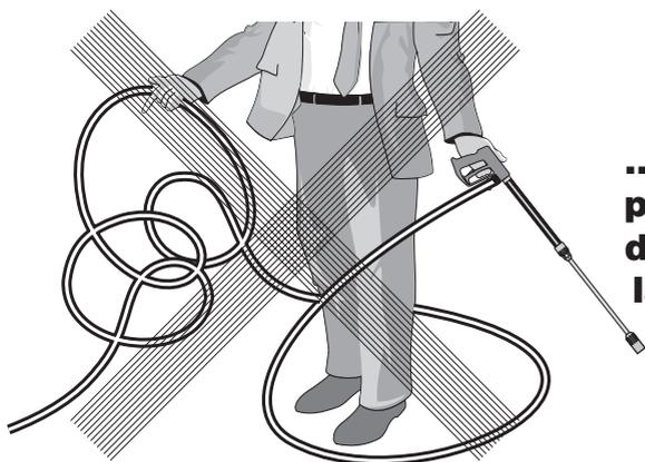
**... tendre le flexible haute pression s'il y a formation de boucles, le tirer ou le laisser frotter sur une arête vive!**
