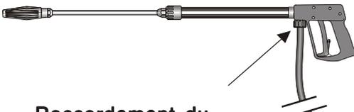
**Raccordement du flexible H.P. de l'appareil à la lance.**
