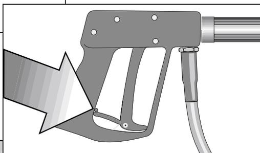
**Lors de l'utilisation de la lance bas de caisse, celle-ci doit absolument être en contact avec le sol avant l'ouverture du pistolet.**
