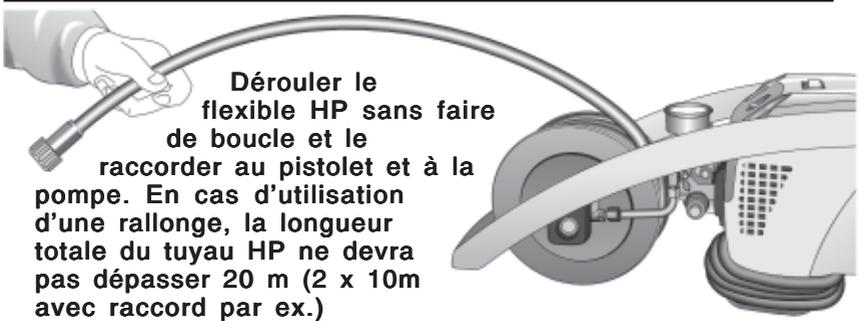
**Dérouler le flexible HP sans faire de boucle et le raccorder au pistolet et à la pompe. En cas d'utilisation d'une rallonge, la longueur totale du tuyau HP ne devra pas dépasser 20 m (2 x 10m avec raccord par ex.)**
