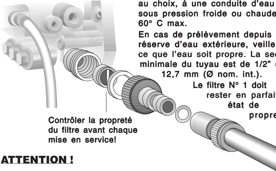
Contrôler la propreté du filtre avant chaque mise en service!
