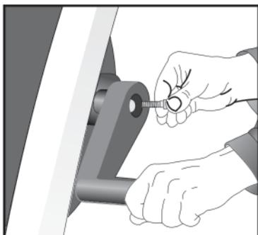
Poser l'appareil verticalement sur le sol, puis enlever l'attache de câble située sur l'axe à six pans de l'enrouleur. Oter la vis de la pièce en laiton, enficher la manivelle sur l'axe à six pans et la fixer en resserrant la vis.
