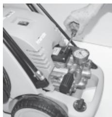
Pour le contrôle du niveau d'huile, dévisser le bouchon d'huile et retirer la jauge. Le niveau d'huile doit se situer entre les deux repères.
