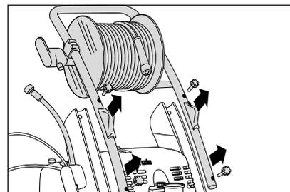
1. Sur les nettoyeurs haute pression avec tambour-enrouleur, la manivelle fournie doit être mise en place et fixée avant la première mise en service. En-ficher la manivelle sur l'axe à six pans et la fixer en resserrant la vis fournie.
