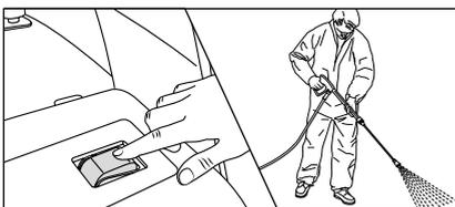
13. Mettre le nettoyeur haute pression en marche, le pistolet Marche/Arrêt de sécurité étant ouvert, puis chasser l'air du nettoyeur haute pression : A cet effet, ouvrir et fermer le pistolet à plusieurs reprises. Le nettoyeur haute pression est désormais prêt pour la réalisation des travaux de nettoyage.
