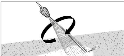
14. En cas d'utilisation de la buse lance à Turbo, veiller à orienter la lance vers le bas avant d'activer le pistolet.
