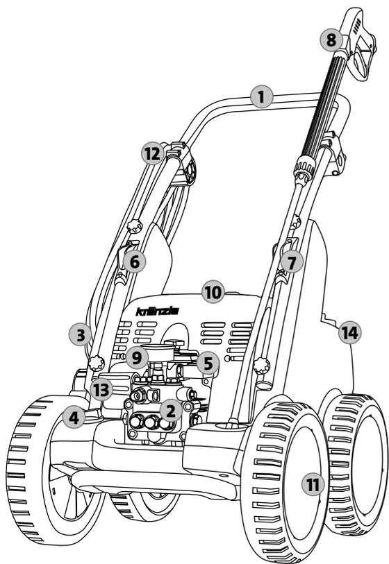
1. Poignée de guidage de forme ergonomique (escamotable)
