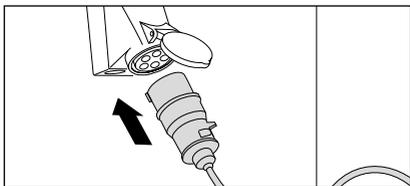
12. Effectuer le raccordement électrique. (voir les caractéristiques techniques) !
