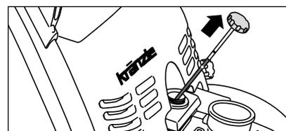
9. Avant chaque mise en service, vérifier si le filtre d'entrée d'eau est propre.
