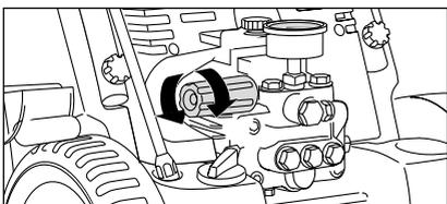
15. Régler la pression de service à la valeur souhaitée à l'aide de la poignée de réglage. La pression maximale disponible est pré-réglée en usine à une valeur fixe.
