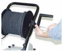
Oter la vis de l'embout de l'axe d'entraînement de l'enrouleur. Libérer la manivelle de son emballage. Enficher la manivelle sur l'axe à six pans et la fixer en resserrant la vis.
