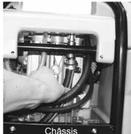
depuis une réserve d'eau externe, il est alors nécessaire de débran-cher le tuyau qui relie la pompe HP au réservoir à flotteur et de brancher le tuyau d'alimentation d'eau directement à la pompe.
