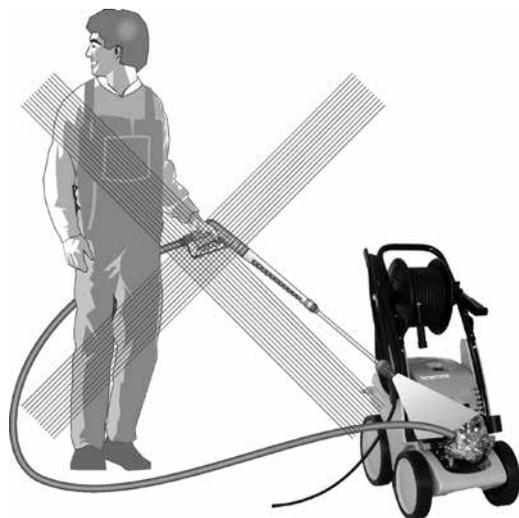
**.. nettoyer l'appareil avec le jet haute pression,**
