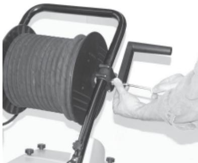
Oter la vis de l'embout de l'axe d'entraînement de l'enrouleur. Libérer la manivelle de son emballage. Enfiler la manivelle sur l'axe à six pans et la fixer en resserrant la vis.
