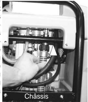
Veiller à ce que l'eau soit propre. Utiliser de préférence le tuyau d'aspiration Kränzle avec filtre d'aspiration (N° de réf.:15.038 3)
