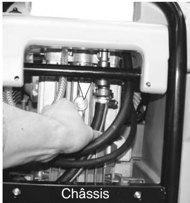
Si l'alimentation en eau du nettoyeur doit être réalisée depuis une réserve d'eau externe, il est alors nécessaire de débrancher le tuyau qui relie la pompe HP au réservoir à flotteur et de brancher le tuyau d'alimentation d'eau directement à la pompe.
