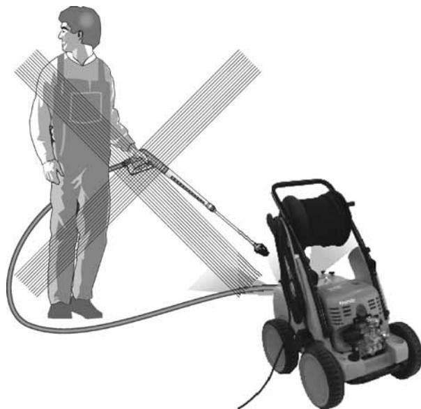
**.. nettoyer l'appareil avec le jet haute pression,**
