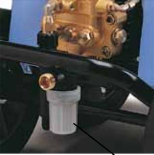
4. Le nettoyeur peut être raccordé, au choix, à une conduite d'eau sous pression froide ou chaude de 70° C max. (Voir page 2). En cas de prélèvement depuis une réserve d'eau extérieure, veiller à ce que l'eau soit propre. La section minimale du tuyau est de 1/2" = 12,7 mm (Ø nom. int.). Le filtre doit rester en parfait état de propreté.
