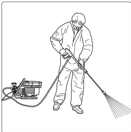
**12.** Mettre le nettoyeur en marche, le pistolet étant ouvert, puis chasser l'air de l'appareil: A cet effet, ouvrir et fermer le pistolet à plusieurs reprises. Le nettoyeur HP est désormais prêt pour la réalisation des travaux de nettoyage.
