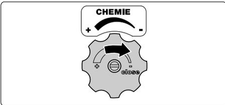
**La vanne de détergent doit être fermée!**
