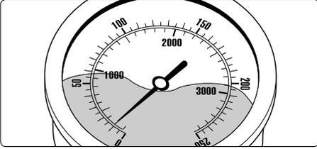
■ Le manomètre n'indique qu'une faible pression et l'eau sort de la buse par à-coups; le tuyau haute pression vibre. Les soupapes sont peut-être encrassées.
