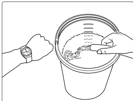
Le manque d'eau se produit bien plus souvent qu'on le croit. Plus un appareil est puissant, plus le risque de manque d'eau est important. Le manque d'eau produit une cavitation dans la pompe (mélange eau-air), ce qu'on ne remarque généralement pas ou trop tard. **Ceci conduit à une détérioration de la pompe.**
