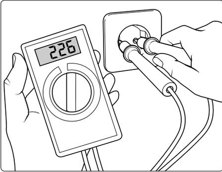
Si un trop grand nombre d'appareils prélèvent simultanément du courant du même réseau d'alimentation électrique, la tension du courant disponible peut chuter sensiblement. Dans ce cas, le moteur du nettoyeur HP peut ne plus fonctionner ou peut même griller.
