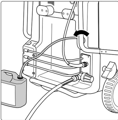
1. Plonger le tuyau d'aspiration avec filtre dans le bidon de détergent.
