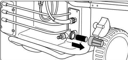
**4.** Avant chaque mise en service, vérifier si le filtre d'entrée d'eau est propre!
