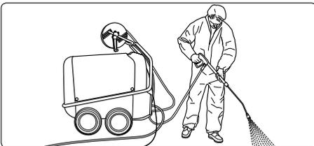
**Au début des opérations de nettoyage, ne pas maintenir le jet haute pression sur l'objet à nettoyer durant 30 secondes au minimum.**
