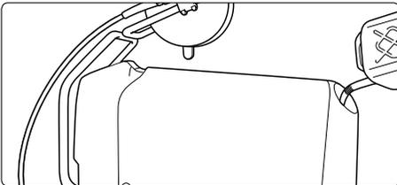
**3.** Mettre du carburant dans le réservoir à combustible. (Fuel léger EL DIN 51603 ou gas-oil)
