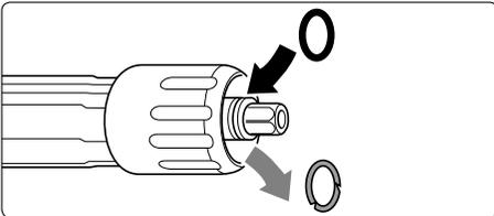
■ **Après la fermeture du pistolet, le manomètre continue à indiquer pleine pression. Le nettoyeur se met en marche et s'arrête sans cesse. Première cause possible: Fuite d'eau**
