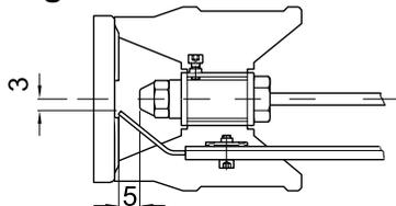
Pour garantir le bon fonctionnement de l'allumage, il est indispensable de contrôler régulièrement le réglage des électrodes (au bout de 500 h de service au plus tard).
