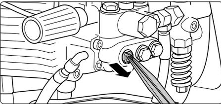
Retirez les corps de soupapes (avec chemises vertes ou rouges en plastique) avec les joints toriques en utilisant une pince à bec pointu. Contrôlez l'état des joints toriques et remplacez-les si nécessaire.
