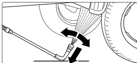
Lors de l'utilisation de la lance bas de caisse, celle-ci doit absolument être en contact avec le sol avant l'ouverture du pistolet. Pour les lances cintrées ou recourbées, le coup de bélier produit un couple de rotation très sensible.
