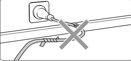
... utiliser un câble électrique qui n'est pas en parfait état, endommager le câble ou effectuer des réparations inadéquates;
