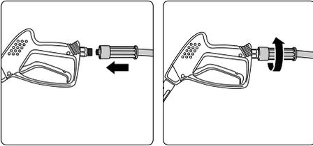
13. Raccorder le flexible haute pression au pistolet.
