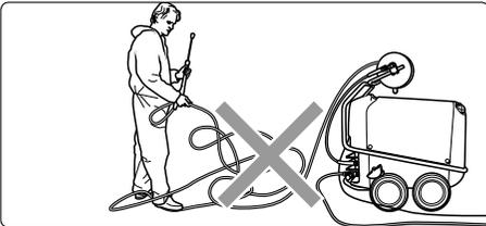
... tendre le flexible haute pression s'il y a formation de boucles, le tirer ou le laisser frotter sur une arête vive;
