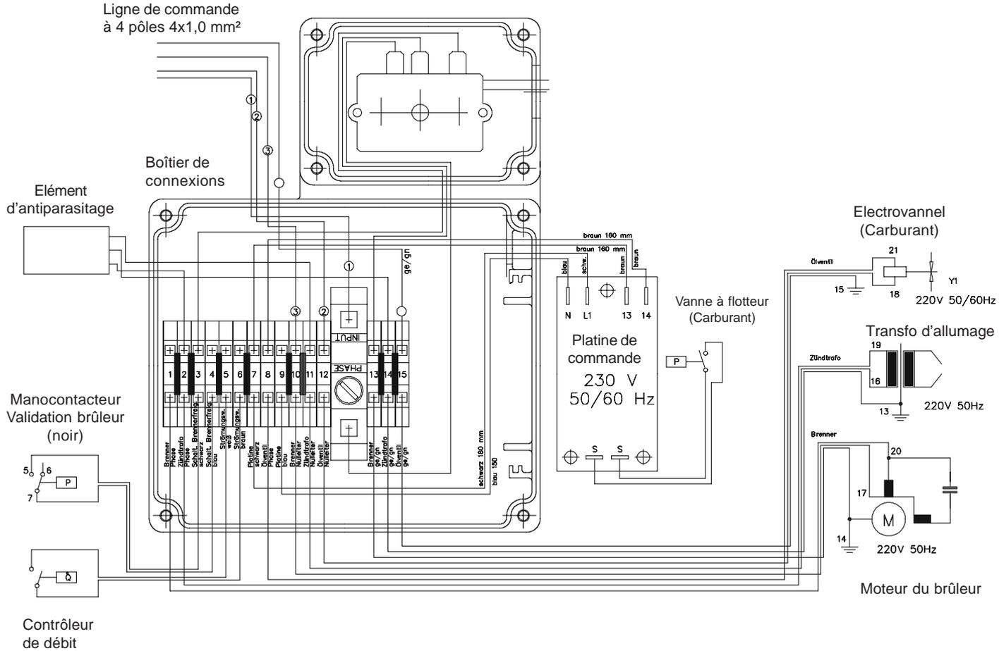
**Schéma des connexions dans boîtier**
