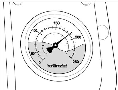
Après la fermeture du pistolet, le nettoyeur HP doit s'arrêter et le manomètre doit alors indiquer la pression de coupure admissible (voir plaquette signalétique). Si le nettoyeur ne s'arrête pas et que le manomètre continue à indiquer pleine pression (l'appareil ne commute pas en by-pass), la cause peut être une fuite au niveau de la pompe haute pression, du pressostat, du flexible haute pression ou du pistolet à fermeture de sécurité.
