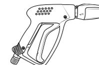
2. Pistolet à fermeture de sécurité avec raccord rapide
