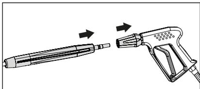
6. Tirer tout d'abord vers l'arrière la douille d'enclenchement du pistolet avant d'insérer la lance dans le raccord rapide.
