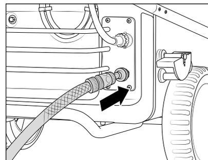
9. Raccorder le tuyau d'eau au manchon d'entrée d'eau (Exigences minimales: tuyau de 5 m de longueur, section de 3/4", 10 bars). Le nettoyeur peut être raccordé, au choix, à une conduite d'eau froide ou d'eau chaude de 60 °C max. (1 à 10 bars de pression d'alimentation). La série therm-1 de puissance élevée permet le prélèvement d'eau d'alimentation depuis un fût (voir Aspiration directe).
