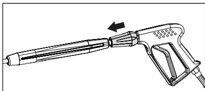
7. Après insertion de la lance dans le raccord, relâcher la douille et vérifier si la lance est bien enclenchée.
