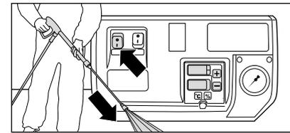
1. Mettre le nettoyeur HP en marche, le pistolet Marche/Arrêt de sécurité étant ouvert, puis chasser l'air du nettoyeur HP: A cet effet, ouvrir et fermer le pistolet à plusieurs reprises. Le nettoyeur haute pression est désormais prêt pour la réalisation des travaux de nettoyage.
