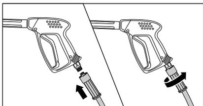
5. Brancher le raccord gris pivotant du flexible HP sur le pistolet Marche/Arrêt de sécurité, puis les visser fermement entre eux pour établir un raccordement étanche à la pression.
