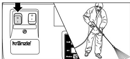
1. Mettre le nettoyeur HP en marche, le pistolet Marche/Arrêt de sécurité étant ouvert, puis chasser l'air du nettoyeur HP: A cet effet, ouvrir et fermer le pistolet à plusieurs reprises.
