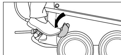
2. Pour le déplacement du nettoyeur haute pression, débloquer le frein d'immobilisation. Ne pas déplacer le nettoyeur haute pression lorsqu'il est raccordé au tuyau d'alimentation en eau!
