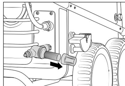
8. En cas d'utilisation d'un filtre d'entrée d'eau, vérifier si celui-ci est propre avant chaque mise en service. Dévisser le boîtier du filtre à la main, ôter le filtre d'entrée d'eau, puis nettoyer et rincer ces derniers avec toutes les autres pièces abondamment à l'eau claire. Un filtre colmaté ne laisse pas passer d'eau et empêche par conséquent une montée en pression.
