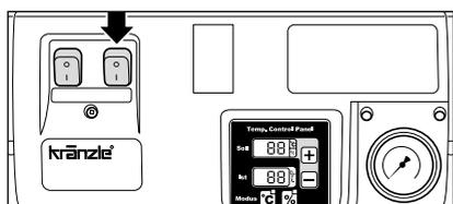
3. Activer l'interrupteur chauffage. L'eau s'échauffe, puis est maintenue en permanence à la température sélectionnée. Le nettoyeur haute pression est désormais prêt pour la réalisation des travaux de nettoyage.
