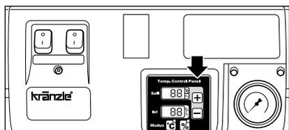
2. Sélectionner au thermostat la température souhaitée (min. 40 °C). Au sujet du réglage du thermostat, voir le chapitre "Informations relatives au fonctionnement" dans le présent manuel d'utilisation.
