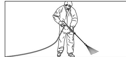
2. Au début des opérations de nettoyage, **ne pas** maintenir le jet haute pression sur l'objet à nettoyer durant 30 secondes au minimum. Il est possible que le volume d'eau contenu dans le serpentin de chauffe ait subi un noircissement pendant la durée de non utilisation de l'appareil.
