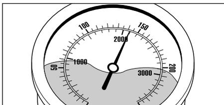
■ L'eau ne sort pas alors que le manomètre indique pleine pression : **La buse est très probablement obturée.** (Le liquide visible dans le manomètre n'est pas de l'eau, mais de la glycérine permettant d'amortir les vibrations de l'aiguille).
