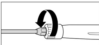
6. Bien serrer le raccord de la lance sur le pistolet Marche/arrêt de sécurité.
