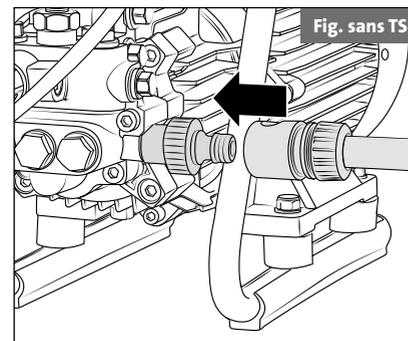
8. Raccorder le tuyau d'eau au manchon d'entrée d'eau (Exigences minimales: tuyau de 5 m de longueur, section de 3/4", 10 bars). Le nettoyeur peut être raccordé, au choix, à une conduite d'eau froide ou d'eau chaude de 60 °C max. (1 à 10 bars de pression d'alimentation). La HD 9/80, HD 9/80 TS, HD 12/130 et HD 12/130 TS permet le prélèvement d'eau d'alimentation depuis un fût (voir Aspiration directe).
