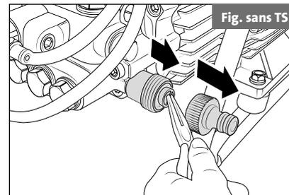
7. **Avant chaque mise en service, vérifier si le filtre d'entrée d'eau est propre.**
