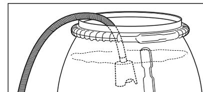
2. Accrocher le tuyau rempli d'eau au fût rempli d'eau et commencer les travaux de nettoyage.
