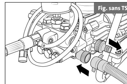
1. Brancher le tuyau d'aspiration avec filtre d'aspiration (N° de réf. 150383).
