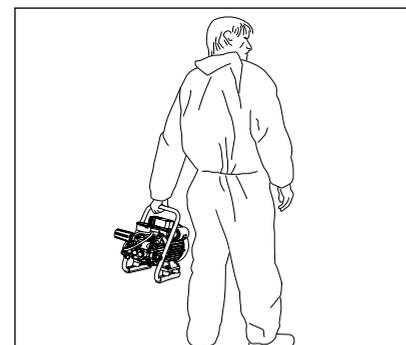
1. Porter le nettoyeur haute pression HD 9/80, HD 9/80 TS, HD 12/130 et HD 12/130 TS vers le lieu de mise en œuvre. Avant de déposer le nettoyeur, s'assurer qu'il puisse être parfaitement immobilisé au sol.
