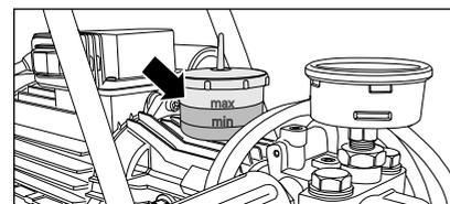
9. **Contrôler le niveau d'huile dans le pot à huile avant chaque mise en service.**
