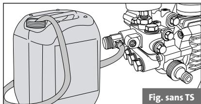
1. Introduire le filtre dans le récipient contenant additifs. Mettre le nettoyeur haute pression en marche, le pistolet Marche/Arrêt de sécurité étant ouvert.
