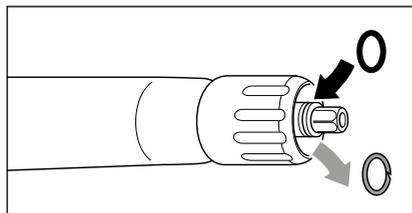
Arrêter l'appareil. Ouvrir brièvement le pistolet pour dépressuriser le système. Débrancher le flexible haute pression, le pistolet et la lance, puis contrôler l'état des joints d'étanchéité. Remplacer immédiatement les joints toriques s'ils sont défectueux.
