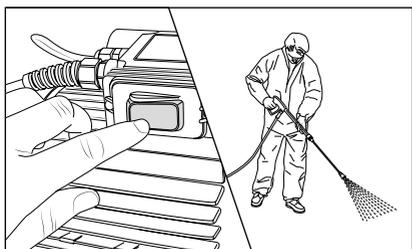
11. Mettre le nettoyeur haute pression en marche, le pistolet Marche/Arrêt de sécurité étant ouvert, puis chasser l'air du nettoyeur haute pression : A cet effet, ouvrir et fermer le pistolet à plusieurs reprises. Le nettoyeur haute pression est désormais prêt pour la réalisation des travaux de nettoyage.
