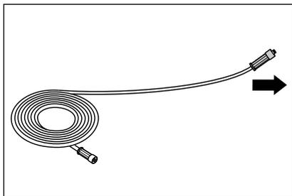
2. Dérouler le flexible haute pression en le tirant dans le sens perpendiculaire à l'axe de l'enrouleur et en veillant à ne pas faire de boucle. (La longueur max. du flexible haute pression rallongé ne doit pas excéder 20 m !) Le flexible HP peut laisser des traces de frottement sur certains sols. En alternative, vous trouverez aussi des flexibles HP Non-Marking dans notre gamme de produits.
