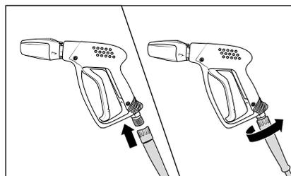
3. Visser fermement le flexible haute pression au Pistolet Marche/Arrêt de sécurité pour établir un raccordement étanche à la pression.
