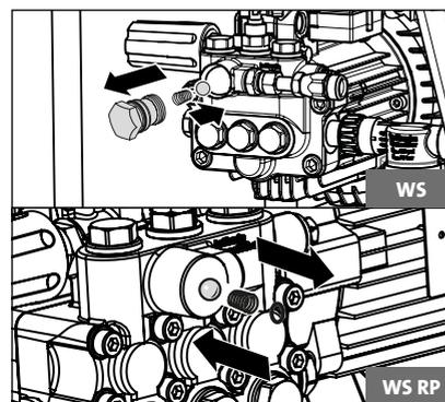
Enlever le barillet anti-retour et s'assurer que le joint torique n'est ni sale, ni endommagé. Contrôler également le siège d'étanchéité dans le carter de pompe haute pression et s'assurer qu'il n'est ni sale, ni endommagé.
