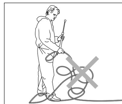
Ne pas tendre le flexible haute pression s'il y a formation de boucles !
