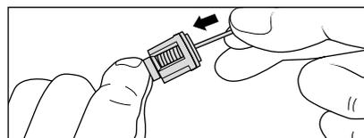
Nettoyer les soupapes avec un fil métallique (trombone) en les passant sous l'eau d'un robinet.
