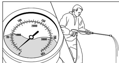
Bien que le régulateur de pression soit entièrement ouvert, le manomètre avec boîtier inox est très faible et un jet d'eau irrégulier sort de la lance. Le flexible haute pression vibre. (Le liquide situé dans le manomètre avec boîtier inox, mais du glycérine permettant d'amortir les vibrations de l'aiguille.)
