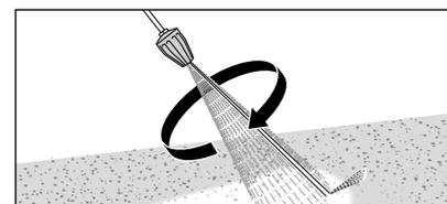
**15.** En cas d'utilisation de la buse lance à Turbo (option) veiller à orienter la lance vers le bas avant d'activer le pistolet.
