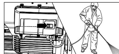
**14.** Mettre le nettoyeur haute pression en marche, le pistolet Marche/Arrêt de sécurité étant ouvert, puis chasser l'air du nettoyeur haute pression : A cet effet, ouvrir et fermer le pistolet à plusieurs reprises. Le nettoyeur haute pression est désormais prêt pour la réalisation des travaux de nettoyage.
