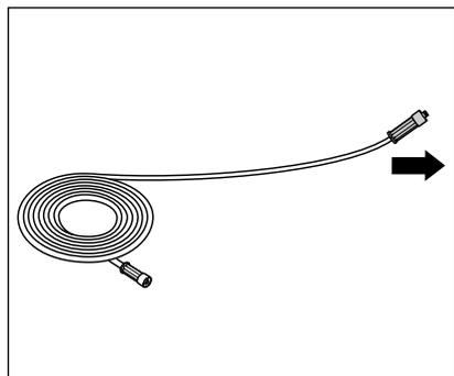
1. Dérouler le flexible HP en le tirant dans le sens perpendiculaire à l'axe de l'enrouleur et en veillant à ne pas faire de boucle. (En cas de rallonge du flexible haute pression, veiller à ne pas dépasser la longueur max. de 20 m !) Le flexible HP peut laisser des traces de frottement sur certains sols. En alternative, vous trouverez aussi des flexibles HP Non-Marking dans notre gamme de produits.
