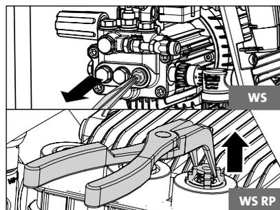
Retirer les vis avec corps de soupapes et joints toriques. S'assurer que les joints toriques ne sont pas endommagés et les échanger si nécessaire.
