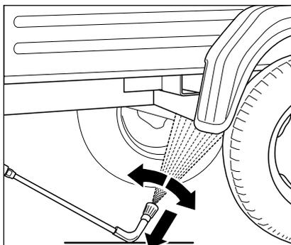
Lors de l'utilisation de la lance bas de caisse, celle-ci doit absolument en contact avec le sol avant l'ouverture du pistolet ! Pour les lances cintrées ou recourbées, le coup de bélier produit un couple de rotation très sensible.
