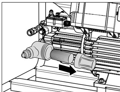
**10. En cas d'utilisation d'un filtre d'entrée d'eau, vérifier si celui-ci est propre avant chaque mise en service.**
