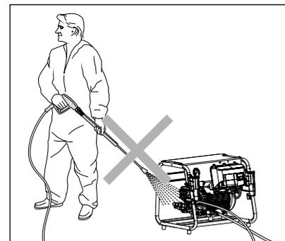
Ne pas nettoyer le nettoyeur haute pression avec le jet haute pression ou diriger le brouillard du jet de pulvérisation sur le nettoyeur haute pression !
