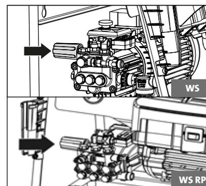
**16.** Régler la pression de service à la valeur souhaitée à l'aide de la poignée de réglage. La pression maximale disponible est pré-réglée en usine à une valeur fixe.
