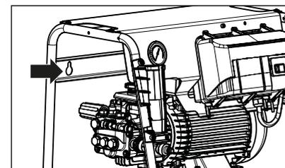
Les œilletons de montage mural se trouvent à l'arrière de l'appareil.
