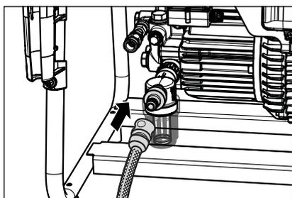
**11.** Raccorder le tuyau d'eau au manchon d'entrée d'eau avec filtre. Le nettoyeur peut être raccordé, au choix, à une conduite d'eau froide ou d'eau chaude de 60 °C max. (1 à 10 bars de pression d'alimentation). La série WS permet le prélèvement d'eau d'alimentation depuis un fût (voir Aspiration directe).
