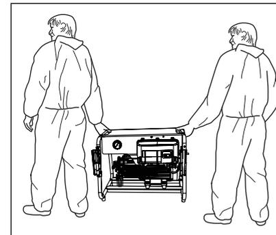
Les appareils de la série WS se laissent porter par deux personnes. Observer le poids du nettoyeur (voir les caractéristiques techniques).
