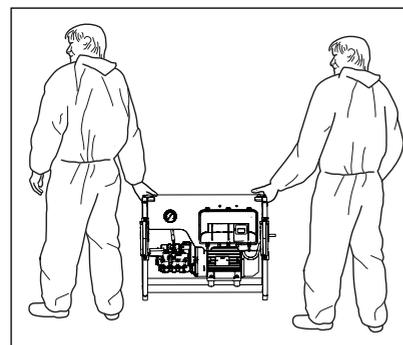
Les appareils de la série WS-RP/WSC-RP se laissent porter par deux personnes. Observer le poids du nettoyeur (voir les caractéristiques techniques).
