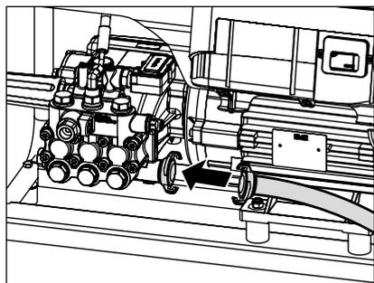
1. Brancher le tuyau d'aspiration avec filtre d'aspiration (N° de réf. 150383).
