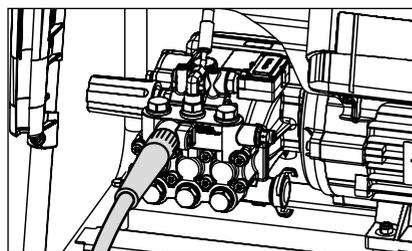
2. le flexible haute pression compris dans la livraison doit être raccordé à la sortie de pompe fermement et de manière étanche à la pression.
