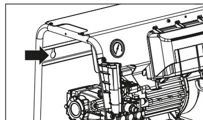
Les œilletons de montage mural se trouvent à l'arrière de l'appareil.
