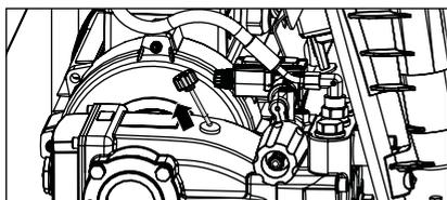
7. **Contrôler le niveau d'huile à l'aide de la jauge de niveau avant chaque mise en service.**
