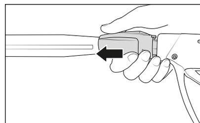
5. Après insertion de la lance dans le raccord, relâcher la douille et vérifier si la lance est bien enclenchée.
