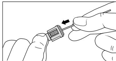
Nettoyer les soupapes avec un fil métallique (trombone) en les passant sous l'eau d'un robinet.
