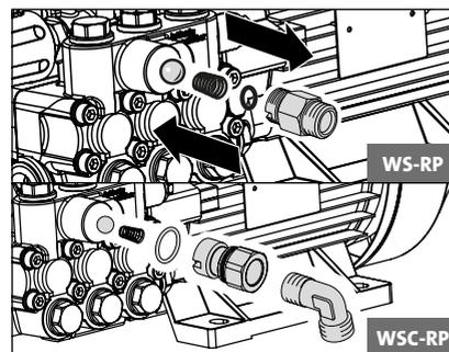
Enlever le barillet anti-retour et s'assurer que le joint torique n'est ni sale, ni endommagé. Contrôler également le siège d'étanchéité dans le carter de pompe haute pression et s'assurer qu'il n'est ni sale, ni endommagé.
