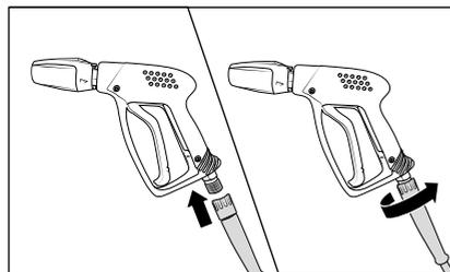
3. Brancher le raccord gris pivotant du flexible HP sur le pistolet Marche/Arrêt de sécurité, puis les visser fermement entre eux pour établir un raccordement étanche à la pression.
