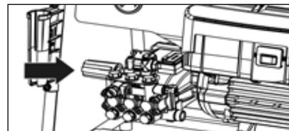
11. Régler la pression de service à la valeur souhaitée à l'aide de la poignée de réglage. La pression maximale disponible est pré-réglée en usine à une valeur fixe.
