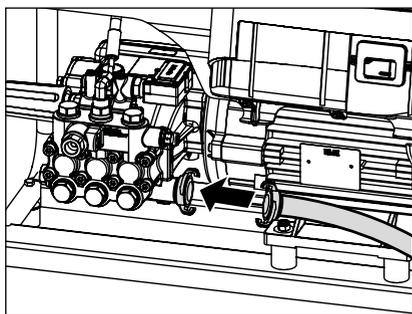
6. Raccorder le tuyau d'eau au manchon d'entrée d'eau (Exigences minimales: tuyau de 5 m de longueur, section de 3/4", 10 bars). Le nettoyeur peut être raccordé, au choix, à une conduite d'eau froide ou d'eau chaude de 60 °C max. (1 à 10 bars de pression d'alimentation). La série WS-RP/WSC-RP permet le prélèvement d'eau d'alimentation depuis un fût (voir Aspiration directe).
