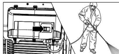
9. Mettre le nettoyeur haute pression en marche, le pistolet Marche/Arrêt de sécurité étant ouvert, puis chasser l'air du nettoyeur haute pression : A cet effet, ouvrir et fermer le pistolet à plusieurs reprises. Le nettoyeur haute pression est désormais prêt pour la réalisation des travaux de nettoyage.
