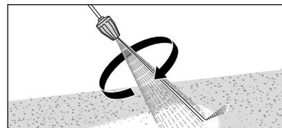
10. En cas d'utilisation de la buse lance à Turbo (option) veiller à orienter la lance vers le bas avant d'activer le pistolet.
