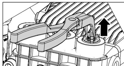
Retirer les vis avec corps de soupapes et joints toriques. S'assurer que les joints toriques ne sont pas endommagés et les échanger si nécessaire.
