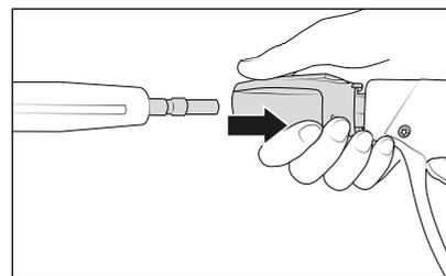
4. Tirer tout d'abord vers l'arrière la douille d'enclenchement du pistolet avant d'insérer la lance dans le raccord rapide.
