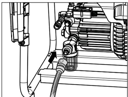
**11.** Raccorder le tuyau d'eau au manchon d'entrée d'eau (Exigences minimales: tuyau de 5 m de longueur, section de 3/4", 10 bars). Le nettoyeur peut être raccordé, au choix, à une conduite d'eau froide ou d'eau chaude de 60 °C max. (1 à 10 bars de pression d'alimentation). La série WS/WS-RP/WSC-RP permet le prélèvement d'eau d'alimentation depuis un fût (voir Aspiration directe).
