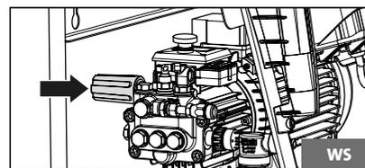
**16.** Régler la pression de service à la valeur souhaitée à l'aide de la poignée de réglage. La pression maximale disponible est pré-réglée en usine à une valeur fixe.
