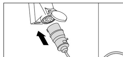
**13.** Effectuer le raccordement électrique. (voir les caractéristiques techniques) !
