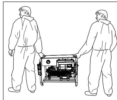
Les appareils de la série WS/WS-RP/WSC-RP se laissent porter par deux personnes. Observer le poids du nettoyeur (voir les caractéristiques techniques).
