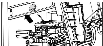
**12. Contrôler le niveau d'huile à l'aide de la jauge de niveau avant chaque mise en service.**
