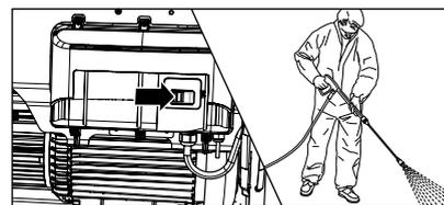
**14.** Mettre le nettoyeur haute pression en marche, le pistolet Marche/Arrêt de sécurité étant ouvert, puis chasser l'air du nettoyeur haute pression : A cet effet, ouvrir et fermer le pistolet à plusieurs reprises. Le nettoyeur haute pression est désormais prêt pour la réalisation des travaux de nettoyage.
